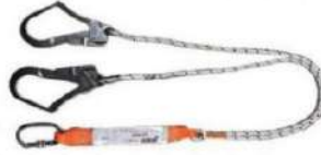
KA343 Çift Kolu Statik Halatlı Büyük Kancalı Şok Emici Malzeme : 12 mm Polyester statik halat EN 354 Şok Emici Gövde : 44 mm Polyester Kolan EN 355 Kanca Durumu : Karabina - Çift Emniyetli Büyük Kanca EN 362 Halat Boyu : 1,20 mt Malzeme Ağırlığı : 1,81 kg
