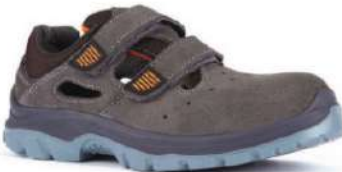
RIO GRP-162 Koruma: S1/S3P Kalıp : GRIPPER Sayı : Silek Deri Astar : 3D Hava Geçirgen File İç Taban : Polyurea Fused Taban: PU/PU Çift Densite SRC Burun Koruma : Kompozit Burun Ara Taban: Multi Protection Kevlar Taban Numara: 36-47"
