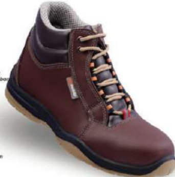
MONTREAL BMK-80 -Taban : Rover Taban -Keruma : S2/S3 -Kafes : ROVER -Soya : Vidula Deri -Astar : 3D Hava Geçirgen File -İç Taban : Soft-Walk -Taban : PU/PU Çift Densite SRC -Burun Koruma : Çelik Burun -Ara Taban : Multi Protection Kevlar Taban -Numara : 36-47"
